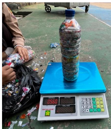
Gambar 4. Cek kepadatan botol ecobrick, berat minimum 0.560 kg
