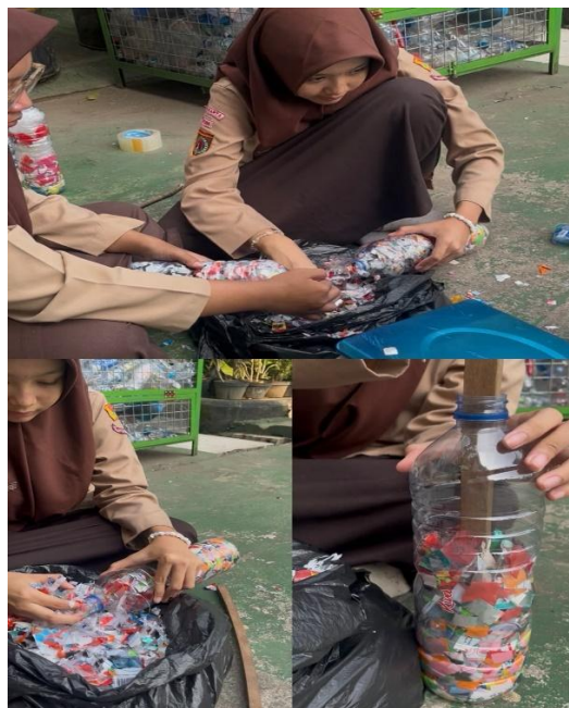
Gambar 3. Proses memasukkan cacahan plastik kedalam botol dan di padatkan menggunakan stik kayu.
