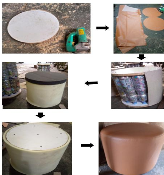
Gambar 8. Sentuhan akhir berbahan kulit sintetis ( oskar ) mentransformasi susunan bata ecobrick menjadi sustainable furniture berestetika tinggi
