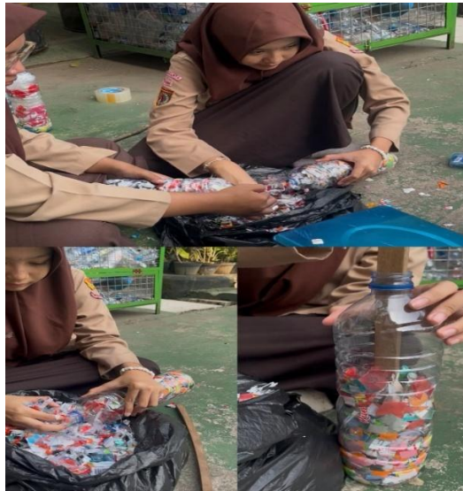
Gambar 2. Proses memasukkan cacahan plastik kedalam botol dan di padatkan menggunakan stik kayu.
